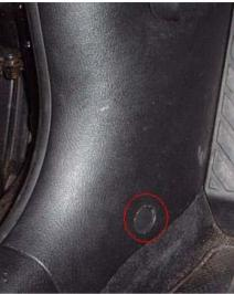
Schritt 2: Entfernt die Fußstütze mithilfe der Ratsche und der 10er Nuss, eventuell ist da eine Unterlegscheibe mit.
